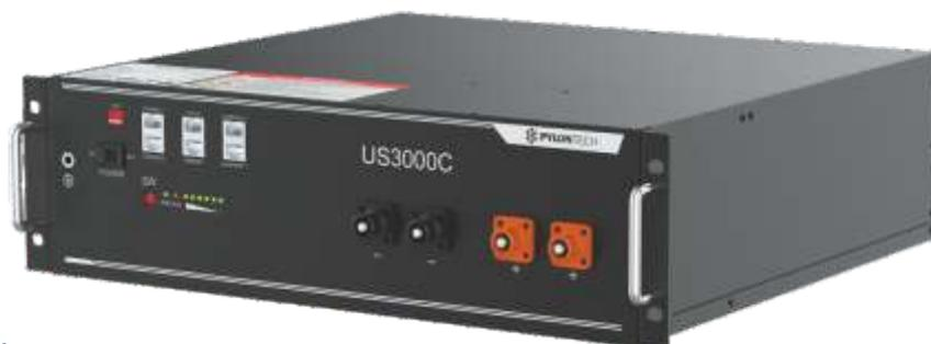
Tra le novità inserite c'è la funzione Soft-Start incorporata in grado di ridurre la corrente di picco quando l'inverter deve partire con la sola batteria. Le batterie US2000C e US3000C dispongono di un BMS integrato in grado di gestire e monitorare le informazioni sulle celle tra cui tensione, corrente e temperatura.
