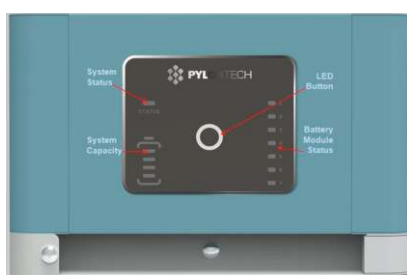
Display del BMS
